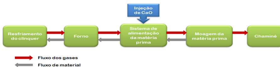
Figura 3. Esquema do processo de fabricação do clínquer Fonte: Os próprios autores, 2012
