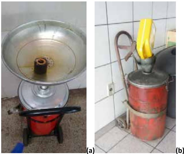
Figura 2. Filtro de óleo e embalagem lubrificante usada passando pelo processo de escoamento do óleo residual.
